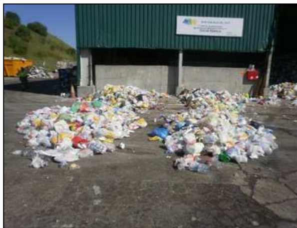
Imagen 3: Procedimiento del cuarteo.
